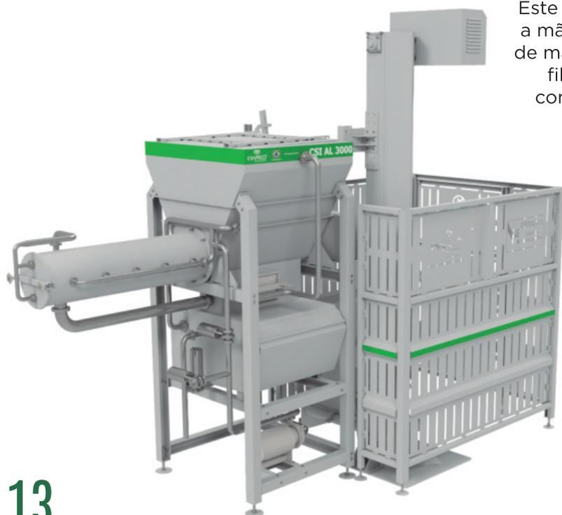
Este equipamento foi desenvolvido para reduzir a mão de obra humana e eliminar o desperdício de massa durante o processo de alimentação da filadeira. Com esse processo não temos mais contato humano com a massa, evitando assim a contaminação cruzada. O equipamento conta ainda com um sensor de nível que emite um aviso em sua IHM e um sinal luminoso ao detectar nível baixo de massa.
