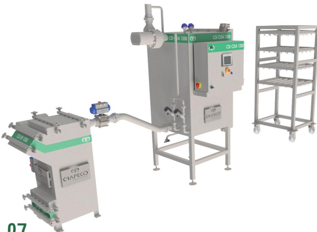
Sistema para defumação para provolone adequado a peças de 400g a 4kg, com gerador de fumaça acoplado e carros para transporte das peças de queijo, controlado por CLP e ajustes via IHM permite ao operador eficiência e agilidade na operação. Com sistemas de exaustão acoplados, a fumaça é direcionada para a área externa sem comprometer a sala de operação.
